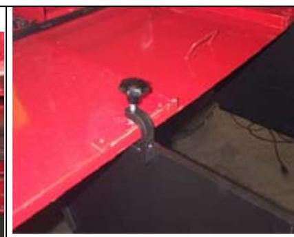
Lors du **hachage**, le capot sera fixé en **position inclinée vers le bas** et les **disques à pales** seront utilisés. Installer les tôles latérales noires dans la **position extérieure maximum**.
