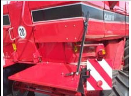
**f)** Montez en haut les rails de réglage (pos. 16), le trou longitudinal en haut, à l'aide de 2 rondelles et d'une vis à garret M 16. Du côté inférieur, utilisez une vis M12, 2 rondelles et un écrou d'arrêt.
