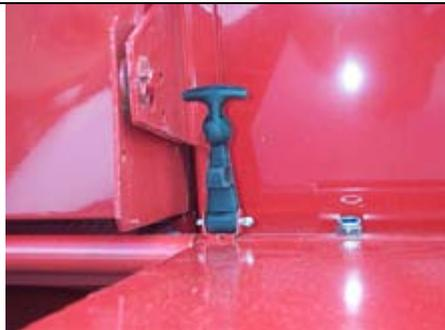
**g)** Montez le support en caoutchouc du capot (pos. 34) avec les goupilles fendues
