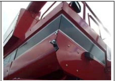
**e)** Démontez à droite et à gauche, la 2<sup>e</sup> et la 3<sup>e</sup> vis du côté inférieur, latéral, arrière du revêtement de la moissonneuse-batteuse et montez à cet endroit le support du réglage de hauteur (pos. 15) avec 2 vis M 10 x 20, 4 rondelles ( 1 interne, 2 d'écart, 1 externe), ressort cylindrique + écrou.
