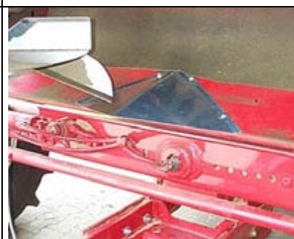
Avant la mise en service, veillez également à ce que la pale à paille ne bute nulle part (contre le recouvrement de l'axe par exemple)
