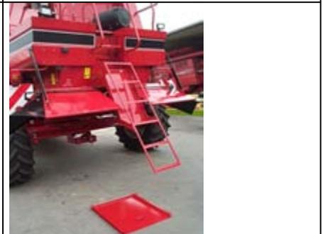
**h)** Glissez la tôle centrale et coincez-la à l'aide du support en caoutchouc du capot.
